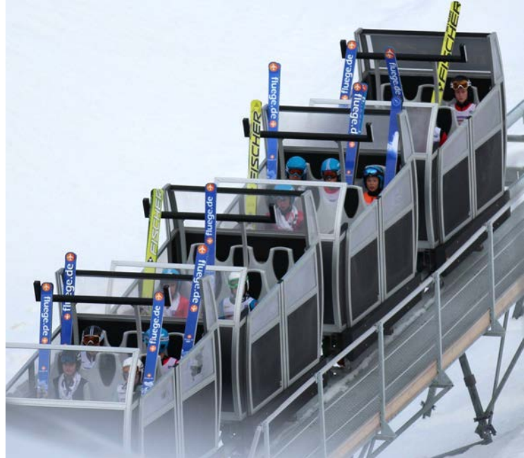
Die neue Berg- und Talbahn der Adlerschanze in Hinterzarten ist eine moderne Zugseil-Lösung von Wiegand, bei der ein Zug aus vier gekoppelten Wagen bis zu 24 Passagiere mit einem Tempo von bis zu 2,4 m/s eine Höhendifferenz von 80 Metern erklimmen lässt. (Bild: Wiegand)
